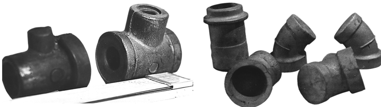
Рис. 5. Образцы изделий из алюминиевого АМг6 и титанового ВТ6С сплавов
